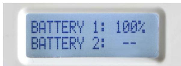
Figura 4: Visualizzazione della capacità della batteria
