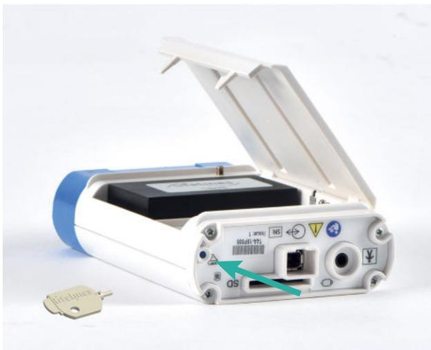
Figura 3: Sostituzione della batteria
