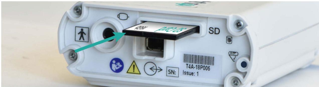
Figura 10: Posizione della Scheda SD (Secure digital)
