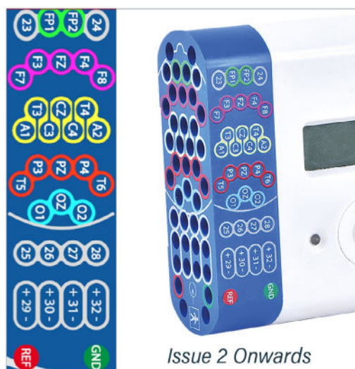
Figur 5: Tilslutning af Trackit T4A-forstærker (PCU (Patient Connection Unit) (tilslutningsenhed til patienten)/forside)
