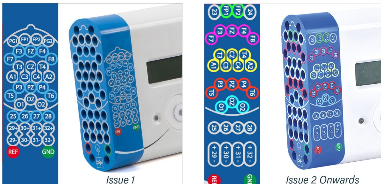
Rysunek 5: Podłączenie wzmacniacza Trackit T4A (PCU/przednia ściana)
